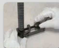
③ 変位計取付ステーをセット
