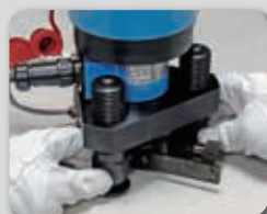
⑤ 3本の脚が試験面に 均等に接するように調節
