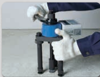
④ メガネレンチでナットを締めながら測定
