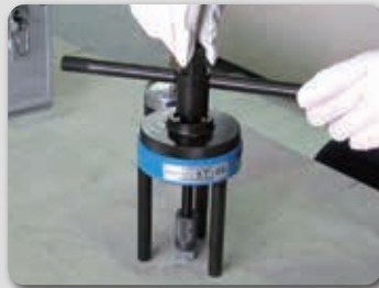
② アンカーにカップリングをねじ込む
