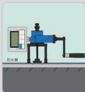
屋上防水層下地の引張荷重確認
