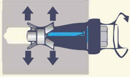
④AXシメボルトをインパクトドライバで"10回転"締付けますと自然と回転が遅くなります。
