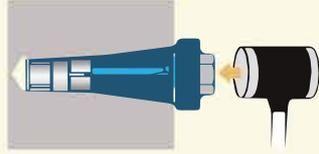
③AXシメボルトをアンカーにセットし、プラスチックハンマー等でALCの面まで軽く叩き込む。
