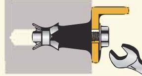
⑤AXシメボルトを外して取付物を設置し、取付け用ボルトを締付けて施工完了。
