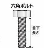
六角ボルトがめねじの本体にかかるように必要首下長さ(表中)以上~アンカー全長以下の六角ボルト(全ねじ)を使用してください。
