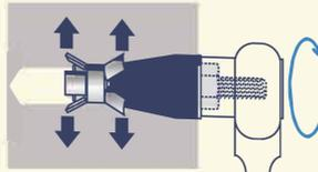
④ラチェットスパナ等を使用し、所定の施工回転数までナットを締付け。
