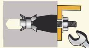
⑤ナットワッシャーを外して取付物を設置し、ナットを締付けて施工完了。
