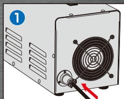
電源ケーブルを溶接機本体(裏側)に差し込み、プラグを電源コンセントに差し込みます。
