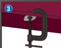
アースを鉄骨の取り付けます。クランプ箇所に塗装、サビ、油等がある場合は除去と表面磨きをしてください。
