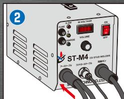
溶接ガン(正面右)、ガンコントロールケーブル(中央)、アースケーブル(正面左)を所定の接続口に差し込み、ロックしてください。
