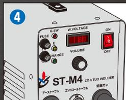
電源スイッチをONにしてください。電圧調整つまみで充電電圧を設定してください。(電圧目安:60V)
