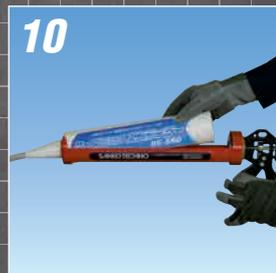
10 カートリッジを専用ディスペンサーにセットしてください。
