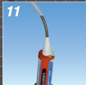
11 ノズルを上に向け、材料が見えるまでトリガーを引いて空気を排出してください。
