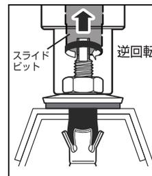
3. ルーフボルトソケットを使用しインパクトドライバで締付け
