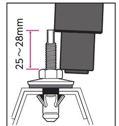
施工完了の目安寸法
