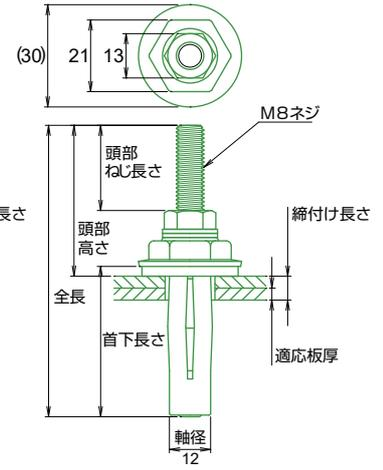
UT-Sタイプ/UTB-Sタイプ ステンレス製(スリーブのみ スチール製 亜鉛ニッケル合金めっき) 単位:mm 単位:N・m 単位:kN
