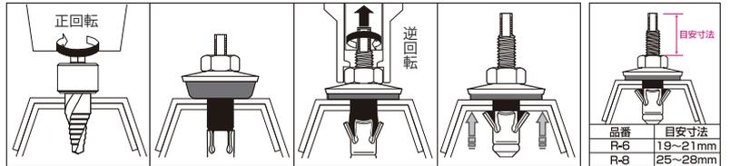
1. ルーフハイビットで穴あけ 2. ルーフボルトをセット 3. ルーフドライバーで締付け 4. 施工完了
