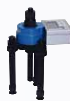
AT-10DⅡ (アンカー非破壊引張試験機) 最大 荷 重: 100kN 最大変位量: 15mm 本 体 質 量: 6.1kg
