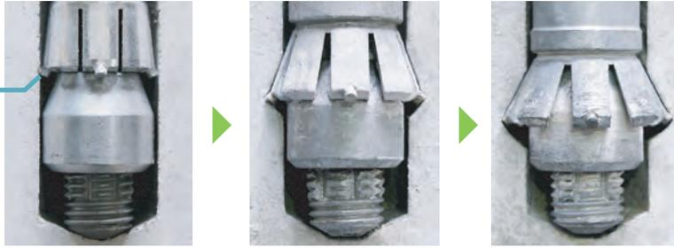
アンカーで孔壁を円錐形状に形成しながら拡底します(セルフアンダーカット方式)。そのため孔とアンカーの拡底部は精確に一致し、工程ごとの完了も目視確認※1できます。拡底用の特殊な穿孔作業が不要で、高強度コンクリート※2への施工も可能です。
