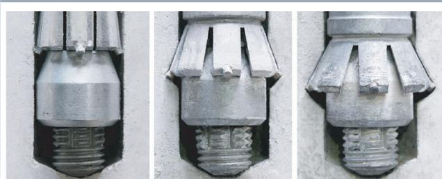
ハンマードリルの回転打撃力でアンカーが孔壁を円錐形状にしながらか拡底(セルフアンダーカット方式)
