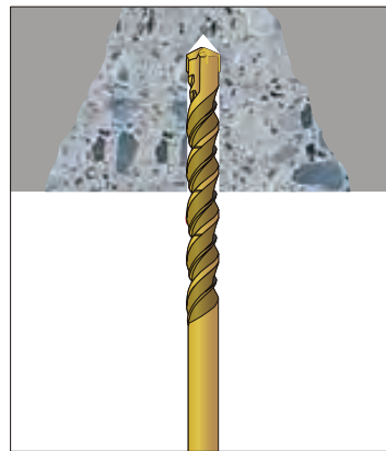
1 穿孔 アンカードリルを使用し、所定の径・深さで穿孔。
