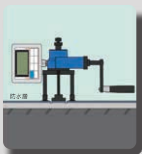
屋上防水層下地の引張試験確認
