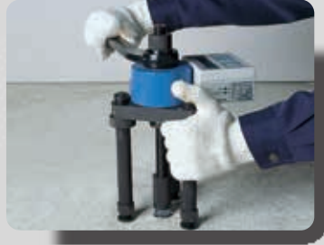
④ メガネレンチでナットを締めながら測定
