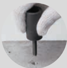
めねじのアンカーにも対応可能 カップリングにめねじ用のボルトをセット
