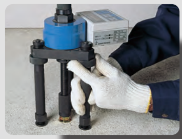
③ 床面の凹凸に合わせて脚の高さを調節
