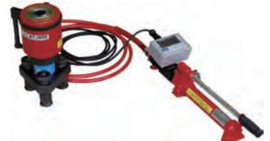
AT-300D II 最大荷重:300kN
