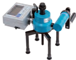
RT-1000LD II 最大荷重:10kN
