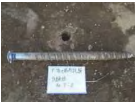
試験体 No. T-2 根入れ 1100mm
