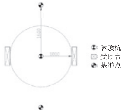
図 4. 試験杭、受け台、基準点の位置関係
