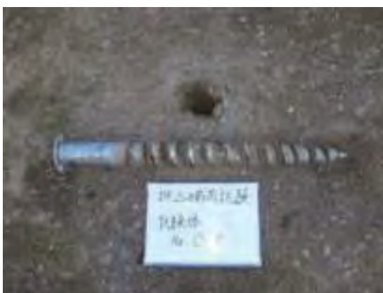
試験体 No. C-1 根入れ 800mm
