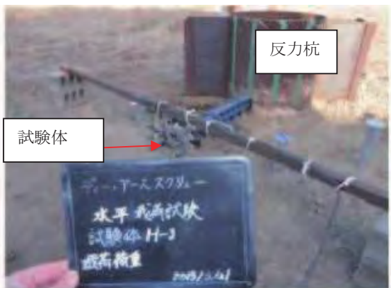
写真 3.4 水平载荷試験装置の全景
