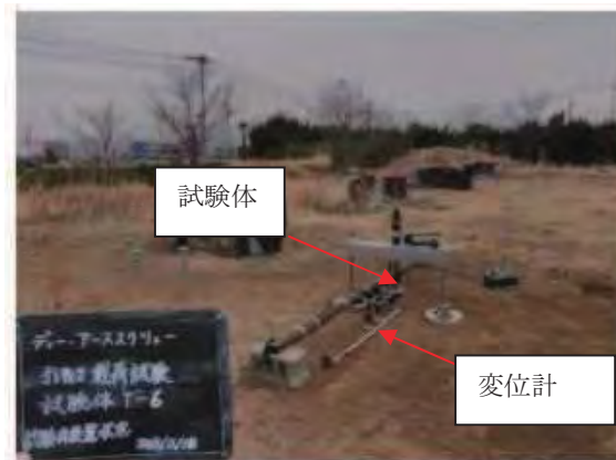
写真 3.3 引抜き载荷試験装置（小型）の全景
