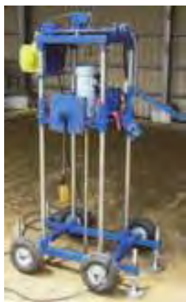
図 4-2 スクリューウェイト貫入試験装置の例
