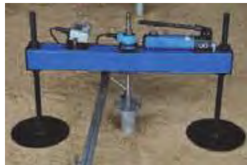
図 1.4-1 小型試験機「テクノテスター」概略図
