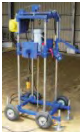
図 2. スウェーデン式サウンディング試験装置
