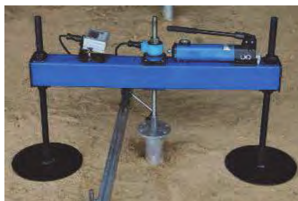
図 4-5 小型試験機「テクノテスター」概略図
