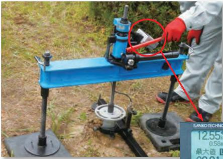
引抜き試験状況
