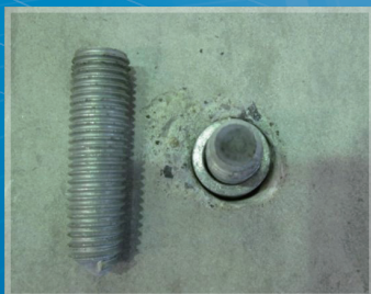
引張試験後の破壊状況
