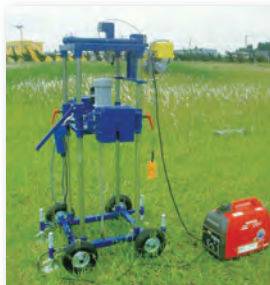
スウェーデン式サウンディング試験機 (サーチU-S型)
