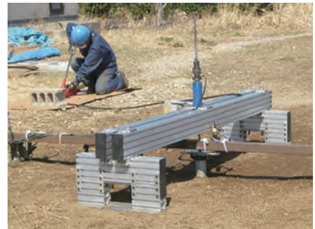
学会式試験装置による引抜き試験実施状況
