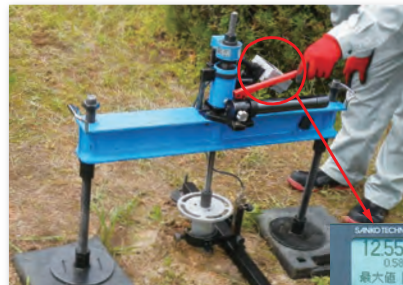
引抜き試験状況
