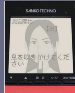
本体に内蔵されたカメラがハーフミラーに映った測定者の顔を自動撮影。測定後は顔写真付きの測定結果がプリントアウトされるため、本人確認に役立ちます。
