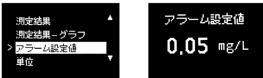
測定値がアラーム設定値を超えるとステータスLEDが赤で点滅し「ピピピピ」と音が鳴り続けます。アラーム設定値以下の場合には緑色のLEDが点滅します。
