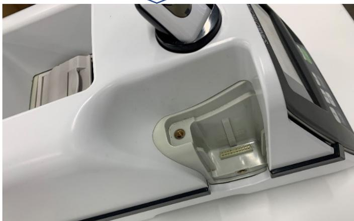
⑤取り外していたセンサーモジュールをつけ直して、ねじを締めます。
