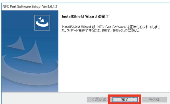
⑩ [NFCPortWithDriver.exe] のインストール完了後、IC免許証リーダーを接続してください。ドライバーが正常にインストールされた場合は、[デバイスマネージャー] に [NFC Port] のアイコンが表示されます。
