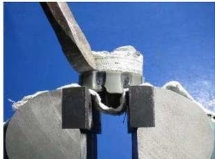
・タガネとハンマーで接着面の付着物を除去する。
