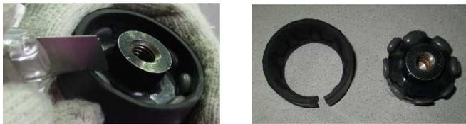
・カッターでサークルグリップの側面に切込みを入れ、剥がす。
