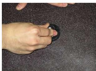
・紙ヤスリでサークルアタッチメント接着面と側面に残った付着物を除去する。
