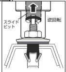
3. ルーフボルトソケットを使用 しインパクトドライバで締付け 内部でスライドビットがボルト
