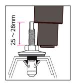
施工完了の目安寸法
