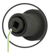
内部のスライドビット がボルトを締付け ながら引き上げる (ストローク管理)
