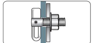
④ 取付け 締結後も簡単に取り外しができます
