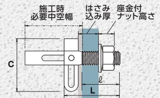
スチール製 三価クロメート処理    ステンレス製 本体：SUSXM7    プレート部：SUS304系    単位:mm    単位:本
