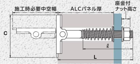
スチール製 三価クロメート処理    ステンレス製 本体：SUSXM7・SUS304系 プレート部：SUS304系
