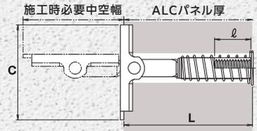
スチール製 三価クロメート処理    ステンレス製 本体：SUSXM7・SUS304系 プレート部：SUS304系
