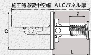
ステンレス製 本体：SUSXM7・SUS304系 プレート部：SUS304系
