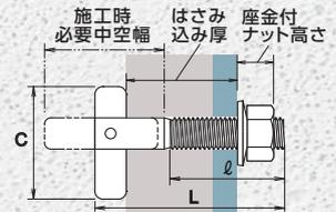
スチール製 三価クロメート処理    ステンレス製 本体：SUSXM7    プレート部：SUS304系    単位:mm    単位:本
