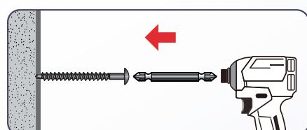
ALCパネル + 薄鋼板(板厚0.8mm以下)へ直接ねじ込む
