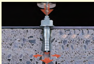
あと施工アンカー
