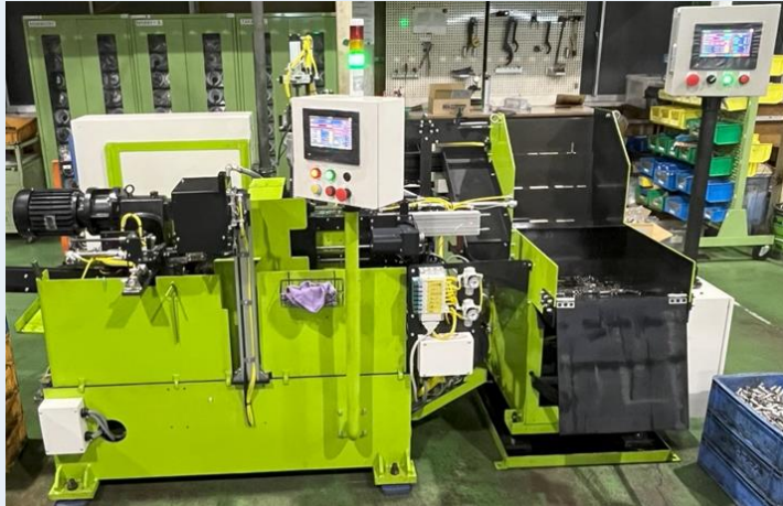
画像選別装置付スリ割機 選別の自動化で生産性を向上 ➤ 2025年6月稼働
